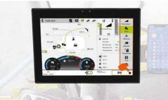
1 tela sensível ao toque CEBIS. O CEBIS responde imediatamente a um simples toque no touch-tela. Você tem acesso direto a todas as funções da máquina – como o menu CRUISE PILOT para as configurações básicas.
