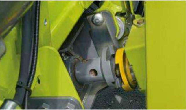
Acoplador de liberação rápida
