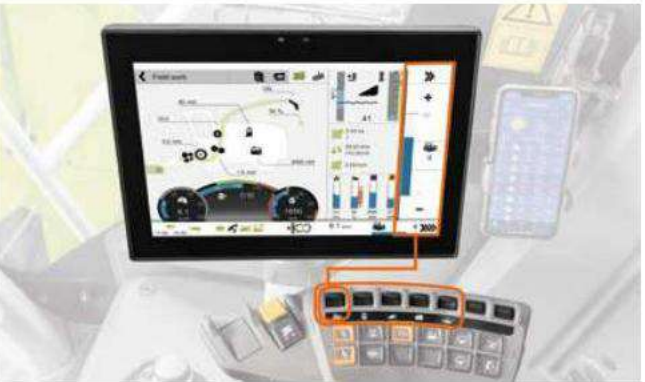
4 Ajuste direto via interruptores. Você opera funções básicas predefinidas diretamente por meio de interruptores atribuídos – por exemplo, para ajustar a largura de trabalho com o interruptor de seção.
