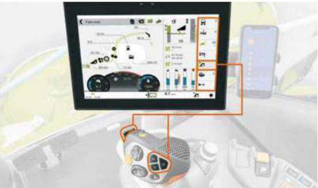
2 Gerenciamento de favoritos do CMOTION. Sete configurações podem ser programadas como favoritas e acessadas por interruptores na alavanca de controle CMOTION. Portanto, você pode se concentrar em observar o encaixe frontal e o fluxo da colheita.
